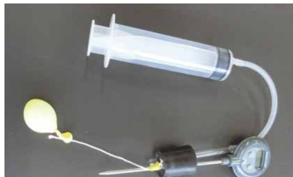
ガラス管・温度計付きゴム栓，シリコン管でつないだ樹脂製の注射器，丸底フラスコの入り口から入る程度の小さな風船と糸。
