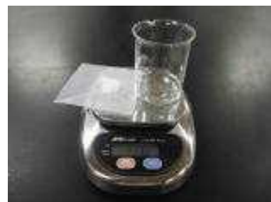
炭酸水素ナトリウムと塩酸の反応前後の質量をはかる。
