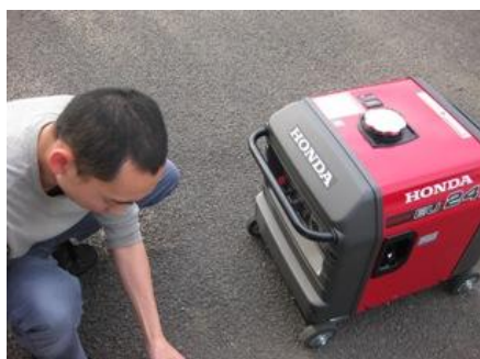
(写真16：発電機を始動する様子)
