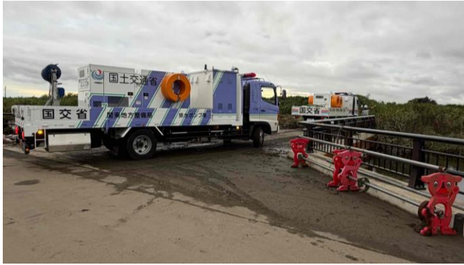
排水ポンプ車の配備(1)
