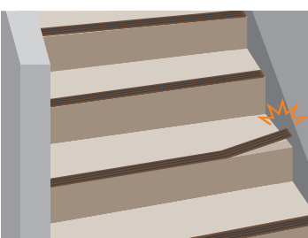
階段の滑り止めの浮き
