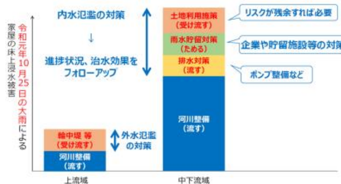
図 2-2 浸水被害対策の基本的な考え方及び3つの視点からの対策
