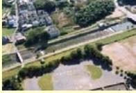
川が本来持つ浄化作用を利用し、水をきれいにする。約80%の浮遊物質、BODを取り除くことができ、一日最大約3万トンの水を浄化できます。
