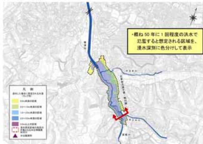
図5.2 椎津川浸水想定区域図(W=1/50)(川間橋上流部抜粋)
