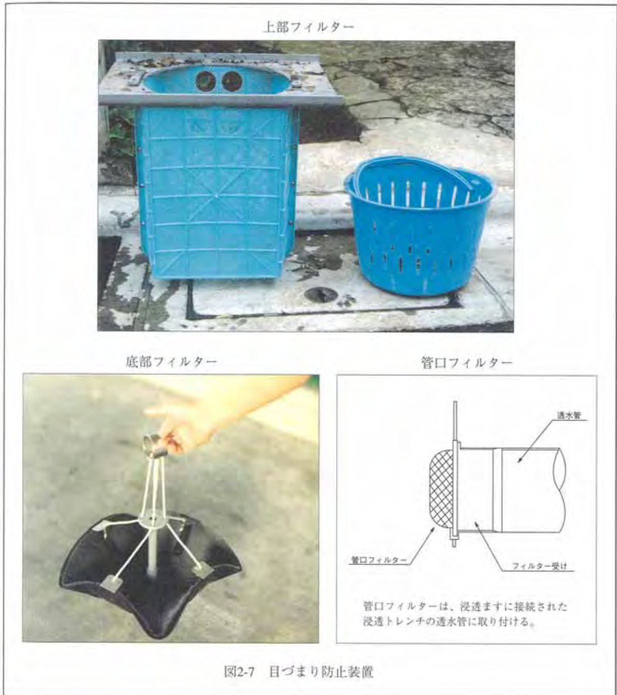
図6-8 目詰まり防止装置の例
