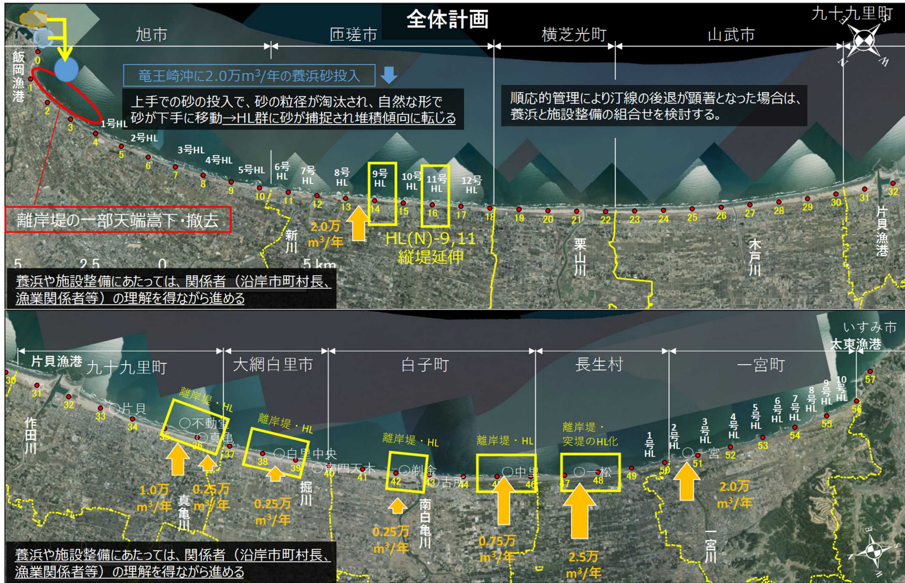
図-3.11 侵食対策 全体計画の整備概要（上：北九十九里、下：南九十九里）
