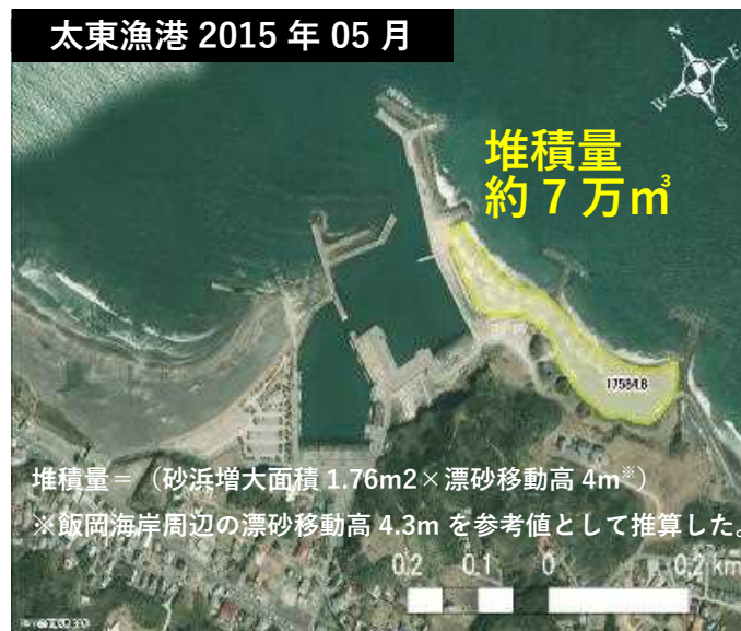
図-2.16 太東漁港周辺の土砂堆積状況
