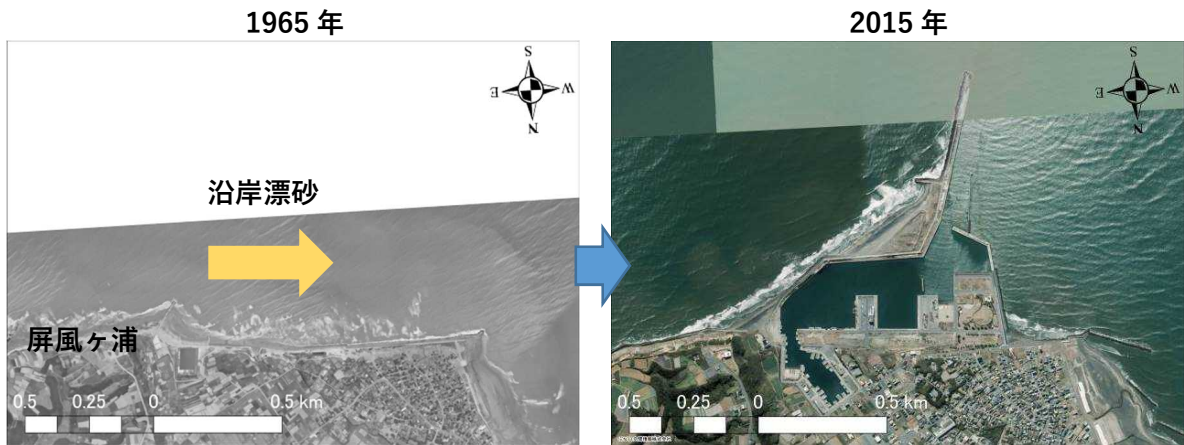
図-2.3 飯岡漁港防波堤建設による沿岸漂砂の捕捉
