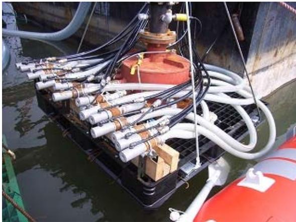
図 1: 微細気泡発生装置
