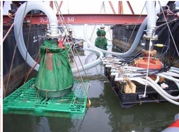
図 2: 微細気泡装置と水中ポンプ
