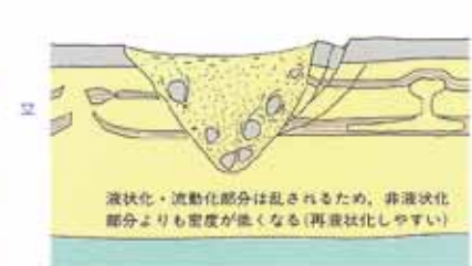
図 1-6 トレンチ調査の結果一部明らかになってきた液状化-流動化のプロセス (出典:アーバンクボタ 40 号)
