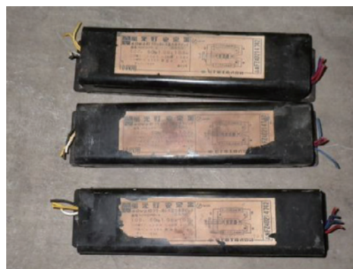
写真 1 PCB が使用された電気機器（左：コンデンサー，右：安定器）
