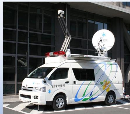
衛星通信車（ちば衛星号）
