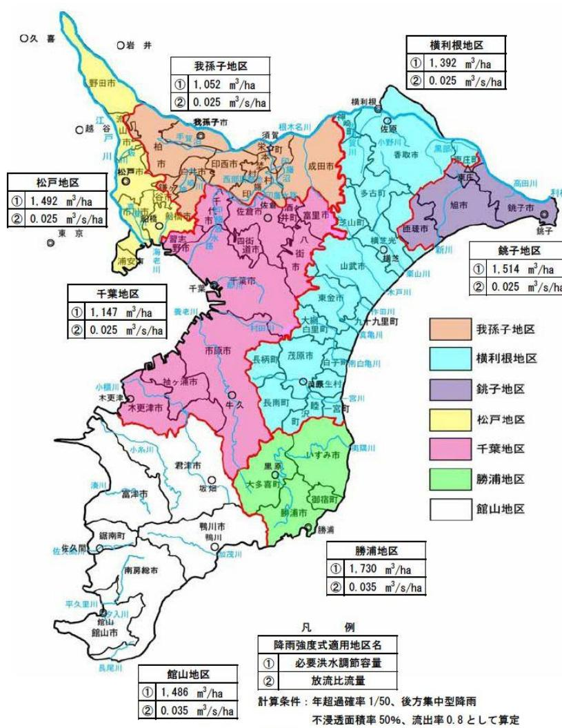
図 降雨強度式適用範囲と洪水調整容量の例
