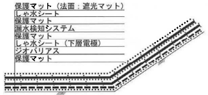
図-18 F処分場構造図 (二重シート検知)
