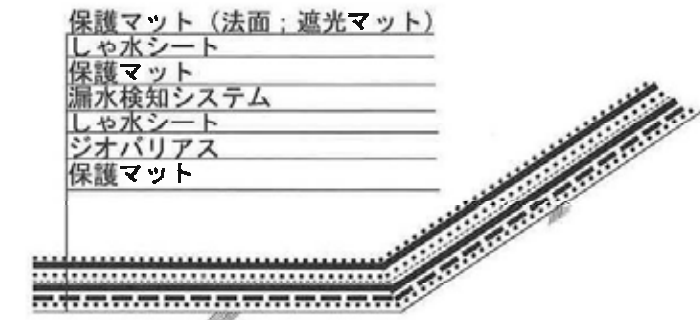
図-14 B処分場構造図 (上層シート検知)
