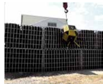
◎ 実物大実験にて、 礫の衝突に対する安全性確認
