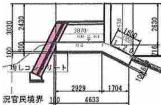
計画断面図：広域河川改修（復興）工事 （護岸工その12）
