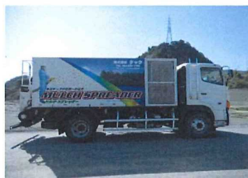
車両搭載型機械とホースの連結で、施工範囲が拡大
