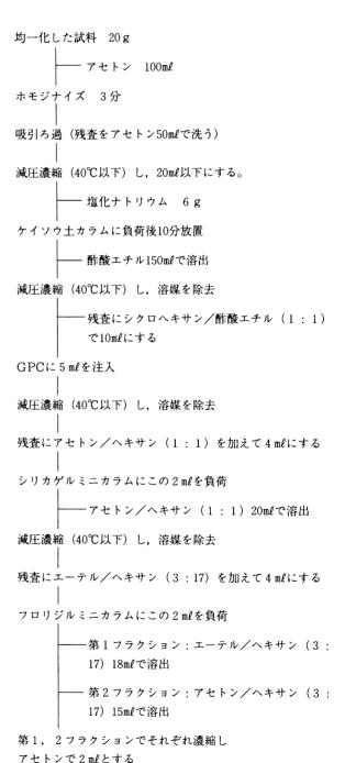
図1 有機塩素系及びピレスロイド系農薬フローシート
