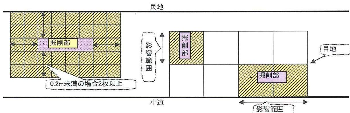
※平板舗装は平板は1枚分(0.3m程度)、コンクリート舗装は目地により区画された1ブロックを影響範囲とする
