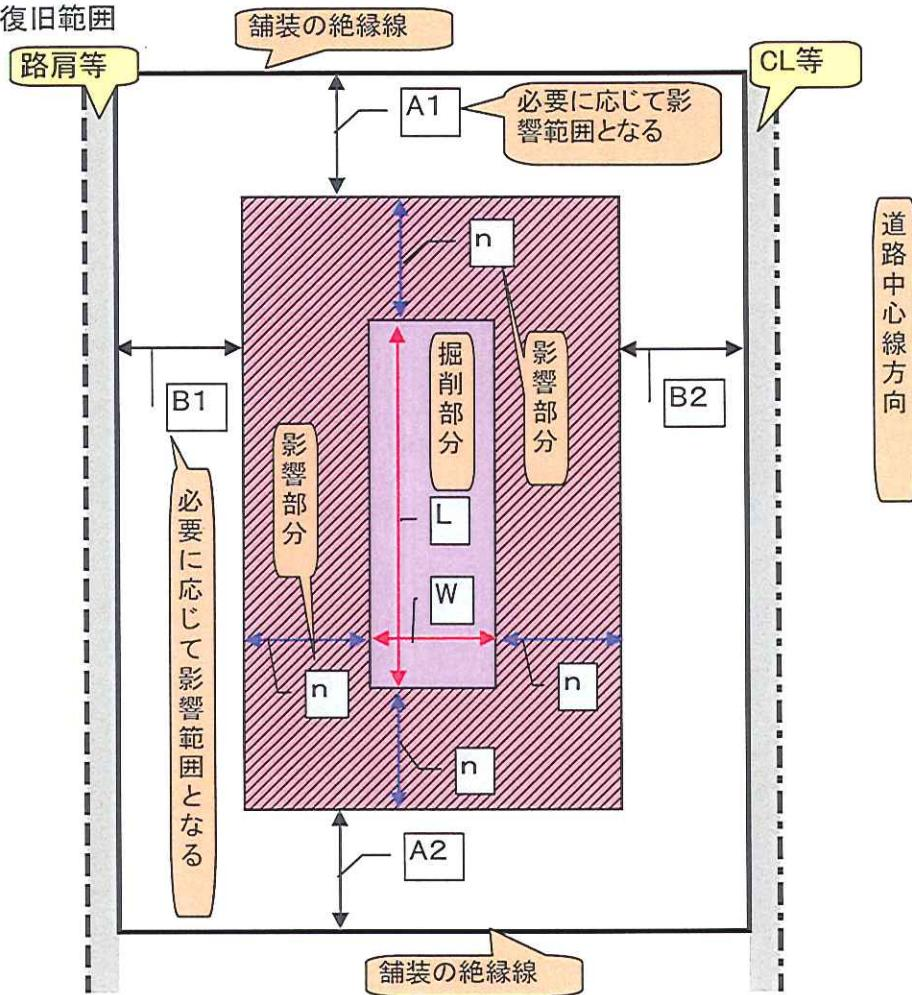
復旧面積は掘削部分( $L \times W$ )、影響部分( $n$ )及び必要によりA1A2B1B2部分を加えたものとし、標準的には次式により算出する。ただし、工事に起因して隣接する既設舗装に欠陥を生じさせた場合(亀裂、落込み、平坦性阻害等)には、その部分を復旧範囲に加えるものとする。
