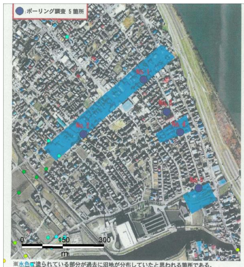
図 4.2-3(5) ボーリングデータの分布 (前回+新規収集分・我孫子市) (上:既存分・下:既存分+新規収集分)
