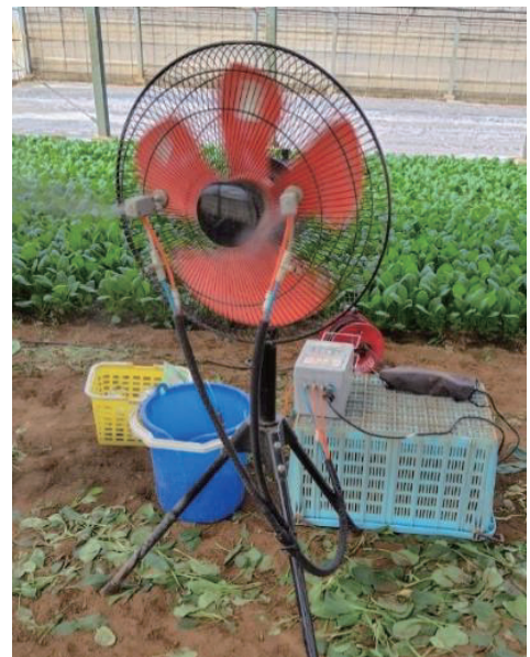
写真1 ミスト発生装置を取り付けた扇風機
