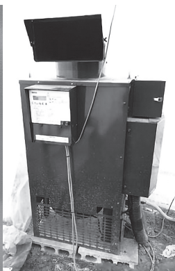
写真2 導入が進む炭酸ガス発生装置(右)及び環境モニタリング装置(左)
