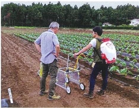
押し車式薬剤噴霧器 ※ノズルを振らず畝間除草が可能
