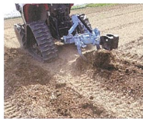
カットブレーカー mini による心土破砕
