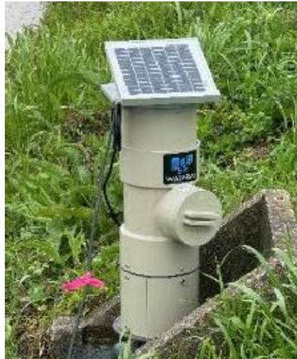
図4 ほ場水管理システム「WATARAS」 電動アクチュエータ直接通信(LTE-M)型
