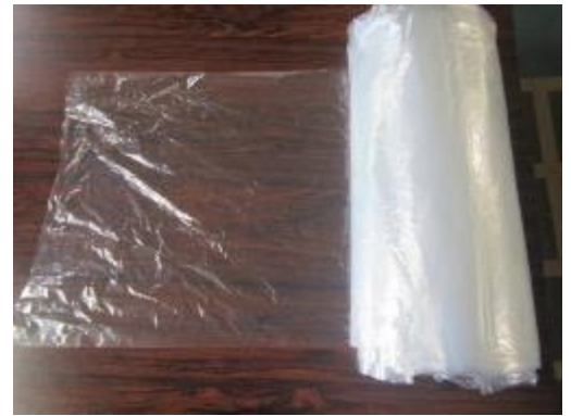
写真7 ポリチューブ (厚み0.03mm 幅450mm)
