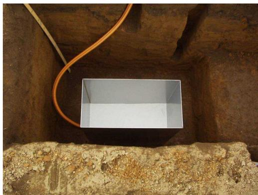
第IV-4-3図 埋設型ライシメータの設置状況
