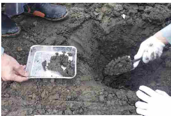
土壌の検査（採取状況）
