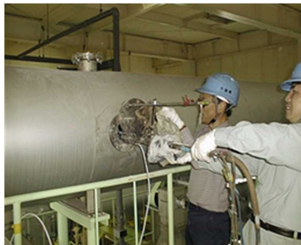
写真 3 煙道の測定の様子（ばい煙）
