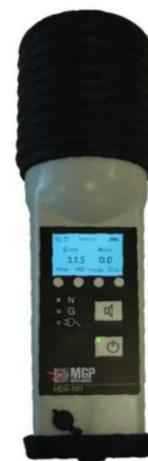
図3 可搬型モニタリングポスト検出器
