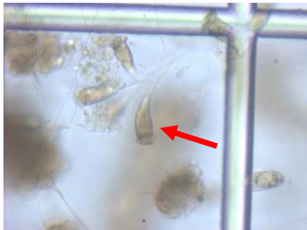
写真5 状態の良い活性汚泥に見られる 生物相（原生動物（ツリガネムシ））
