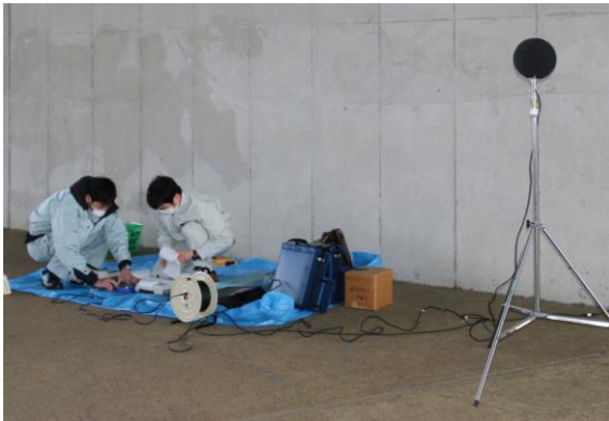
現場での騒音測定調査
