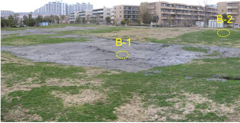
図2 ボーリング地点付近の状況。B-1は太平洋沖地震後に多量の砂が噴出した場所。B-2は噴砂や噴水が無く地表面の変形もなかったB-1よりも0.5mほど高い場所。
