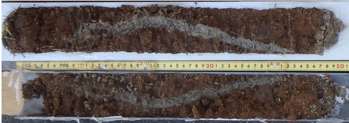
図4 B-1での地表～深度0.5mのオールコア試料(下)とコアの剥ぎ取り標本(上)。関東ローム層由来の赤褐色の盛土アソシエーション中に幅2cmの灰色の細粒砂からなる噴砂脈がみられている。
