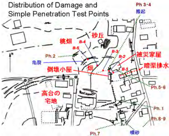
図 1 被害地周辺の状況と貫入試験の位置
