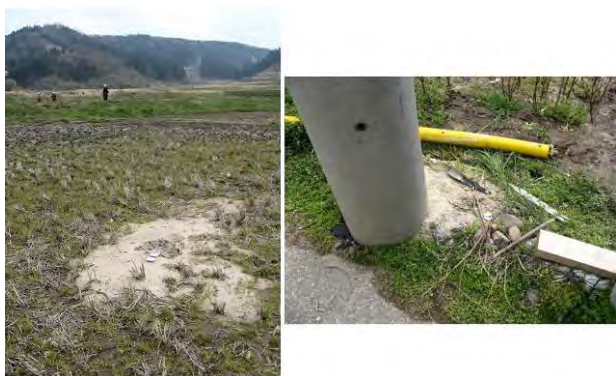
図6 道下地区南部の微高地の裏側にみられた噴砂（砂はアレナイト質の細粒砂である。）
