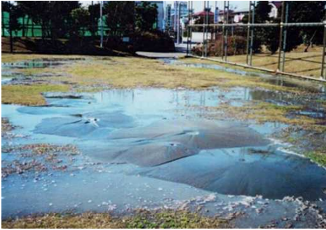
写真38 中磯部公園内の東方沖地震時に直線状に並んだ噴砂。
