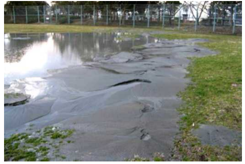
写真39 太平洋沖地震では人工地層の砂層分布の全域が液状化—流動化し沈下した。
