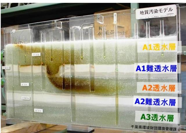
図7 汚染の移流状況
