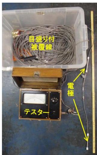
図 I-14 スクリーン検層用に作られた電気検層装置の例
