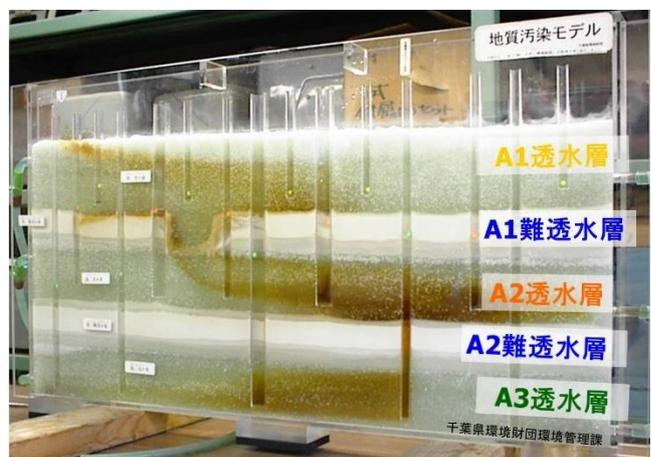
図8 汚染の移流状況
