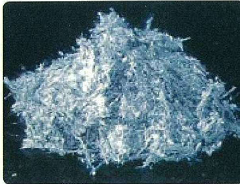
青石綿(クロシドライト)
