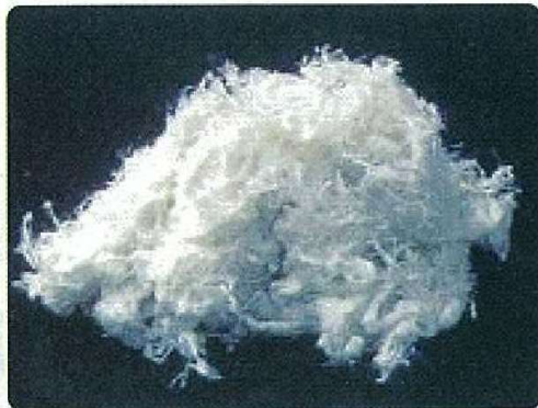
白石綿(クリソタイル)
