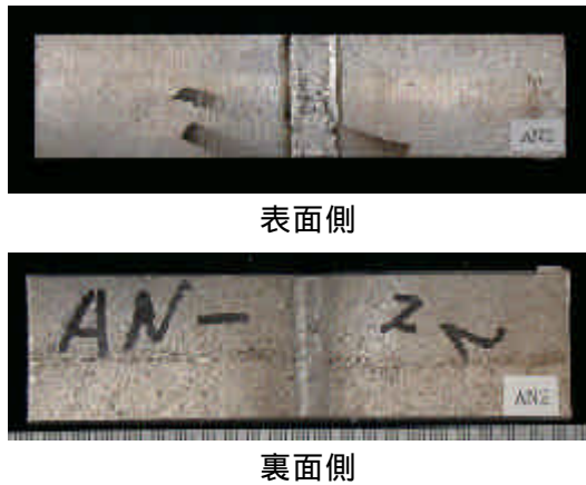
写真4 引張試験体の採取片
