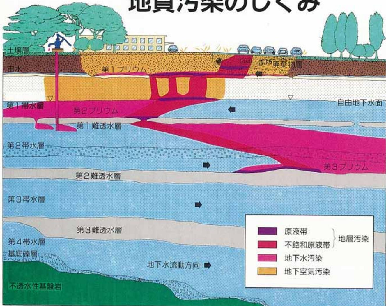
私たちの足元にある地層は、れき・砂・シルト・粘土などの地層粒子からできています。そして、地層粒子と地層粒子の隙間(すきま)に、地下水や地下空気が存在します。
