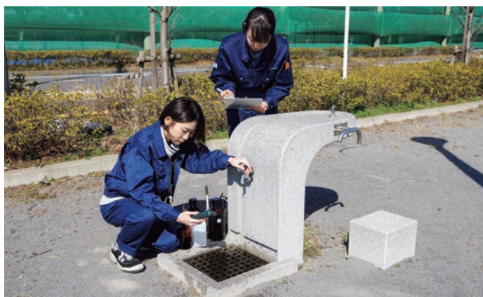
給水栓（蛇口）における水質調査
