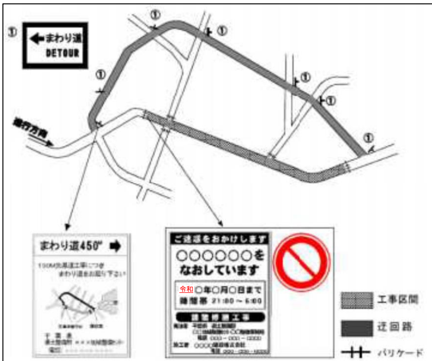
参考（3） 工事中迂回路の表示例（地方部の場合） （進行方向に対する標識の設置例を示す）
