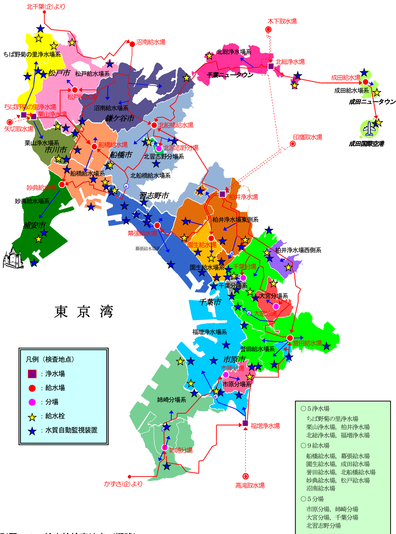
別図－3 給水柱検査地点（概略）
