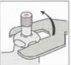
カバーナットをゆるめてはずします。
