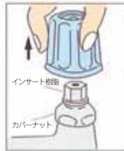
ハンドルを上に引き抜き、インサート樹脂も同じように上に引き抜いてください。
