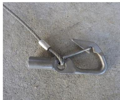
保定器材は2m程度の棒に装着します。器具に付属するワイヤーの端には、捕獲地点周辺の木に結び付けられるよう、長めのロープを繋いでおきます。
