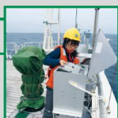
エアロゾルサンプラー 掃除機のように空気を吸引してフィルター上に粒子を採取し分析します
