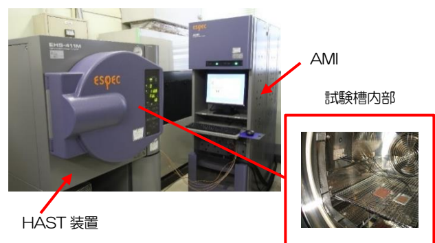
図1 HAST装置及びAMI
